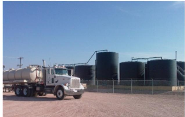
Figure 7 : Déchargement de camion dans une batterie de réservoirs pour stockage et séparation du pétrole et de l'eau salée
