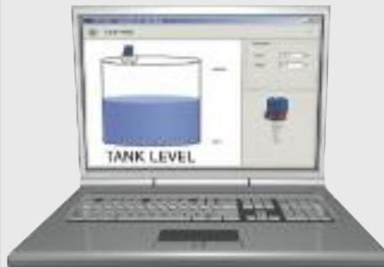
**Bequeme, leichte Konfiguration:** Konfigurierbar über Tastatur, digitale Kommunikation mit HART- oder PACTware™-Software. Damit ist eine vollständige Konfiguration über die lokale Benutzerschnittstelle oder fern mit der zusätzlichen Funktion der Erfassung von Echowellenformen und der Ansicht von Trenddaten, Diagnosebedingungen sowie allen Konfigurationsparametern möglich.
