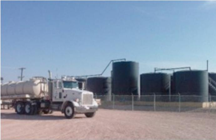
Tankwagen beim Entladen in eine Tankanlage für die Lagerung und Abscheidung von Salzwasser und Öl
