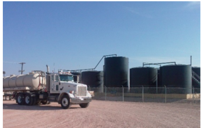
Figura 7. Autocisterna che scarica acqua salata e flowback per la separazione e conservazione dell'acqua salata e dell'olio
