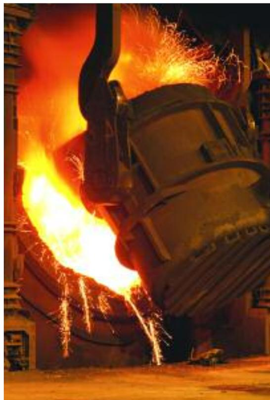
L'industria dell'acciaio è il più grande utilizzatore al mondo di ossigeno. L'aria arricchita di ossigeno aumenta le temperature di combustione negli altiforni e nei forni Martin aperti.
