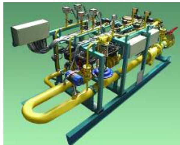
Questo skid per la rigenerazione del glicole, in servizio presso un giacimento di gas naturale in Olanda utilizza tre TA2—due che misurano il flusso dell'aria verso un inceneritore e uno che misura il gas naturale.
