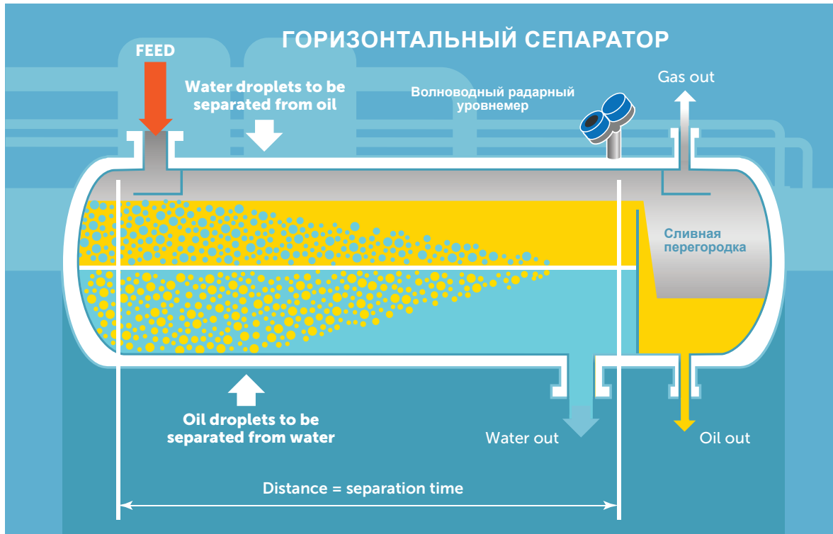
Рисунок 6. Время удержания определяет качество сепарации и эффективность работы измерительного прибора. Обратите внимание на место монтажа волноводного радарного уровнемера синего цвета
