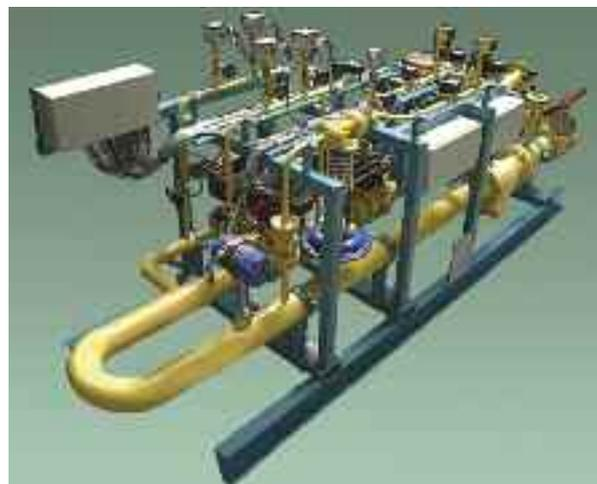
Этот блок регенерации гликоля, работающий на месторождении природного газа в Голландии, использует два расходомера TA2 для измерения потребления воздуха печью, а один такой прибор используется для измерения расхода природного газа.
