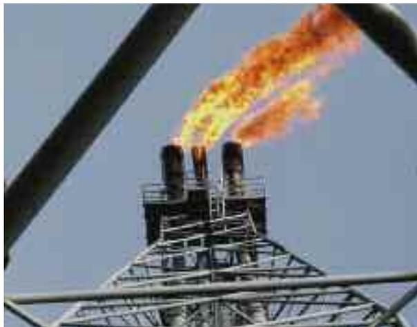
Сегодня нефтеперерабатывающие и химические заводы нередко сжигают отработанные газы на факеле. В связи с изменчивостью состава и расхода газа в этой линии TA2 можно использовать для учета лишь относительного расхода.
